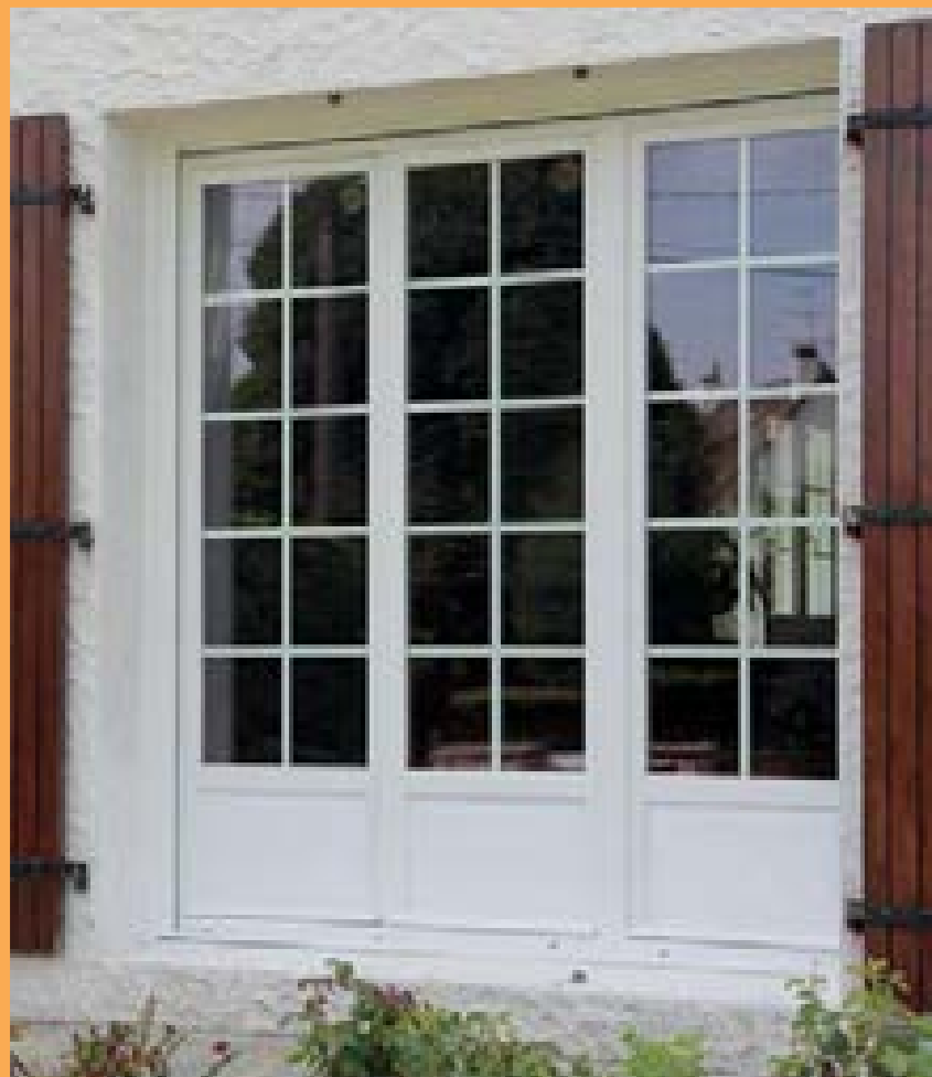
Porte-fenêtre 3 vantaux avec panneau plate bande et petits bois blancs 26 x 8. Seuil ALU blanc double feuillure avec bavette ALU rapportée.
