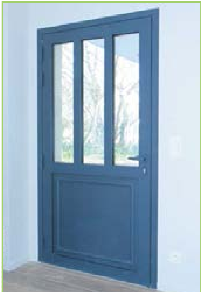
Porte gris anthracite RAL 7016 texturé. Traverse intermédiaire, panneau isolé avec moulures rapportées et double vitrages avec menaux et parcloses droites.
