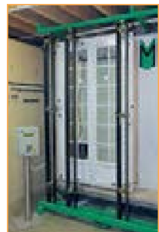
Tests réalisés sur banc d'essai A.E.V. dans nos ateliers. Fréquence hebdomadaire.
